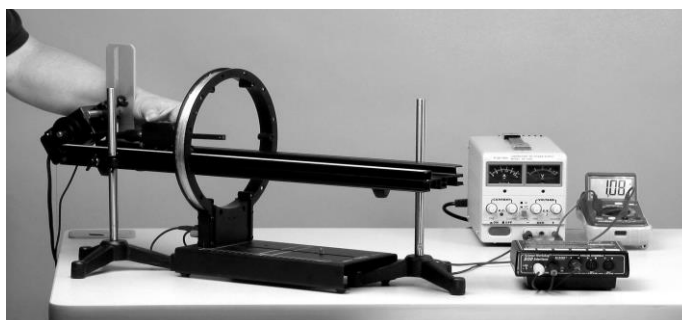
Hình 5: Lắp đặt cuộn dây đơn
